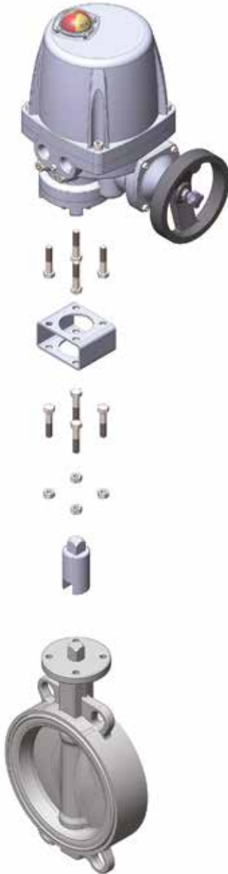
Şekil 6. Elektrikli Aktüatörün Vanaya Braket ile Montajı
